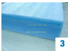
como Ethafoam, la espuma de polietileno se puede usar como material para amortiguar ya que se puede tallar fácilmente según la forma del objeto para contenerlo dentro de su empaque con el objetivo de absorber golpes.
